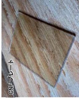
図 1 CNF プレートの作製プロセス・厚み約 1.2 mm の CNF プレートの外観
