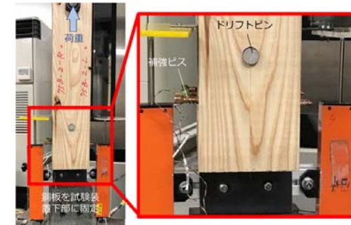
図3 実験の様子。鋼板を試験装置下部に固定した状態で木材に上方向の荷重を与え、図1で示すような荷重条件を再現した。この時、木材に特殊な加工を施し、補強ビスにはひずみゲージを埋め込むことで、ビス軸力(割裂を発生させる応力)を測定した。
