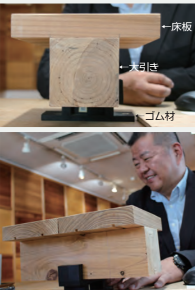
写真2 PCT国際特許申請 弾性剣道場床の模型
